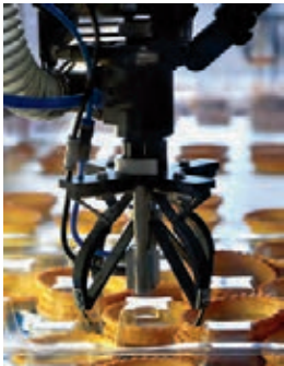
L'élasticité des systèmes compliants assure une préhension douce des objets les plus délicats.
