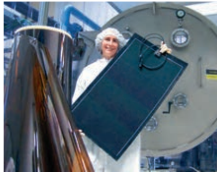
L'installation de production de Flisom: à gauche un rouleau de polyimide qui sert de substrat pour l'application sous vide des cellules solaires à couche mince flexibles (© Flisom AG).
