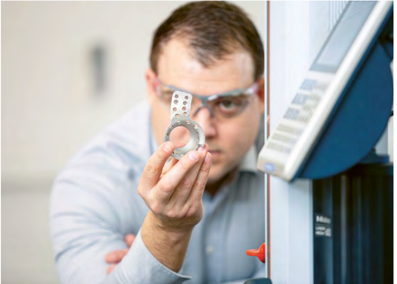
Plaque de renforcement produite par impression 3D pour la fixation d'un insert de prothèse de hanche artificielle, destinée au traitement de fractures complexes du bassin. Image: Swiss m4m Center
