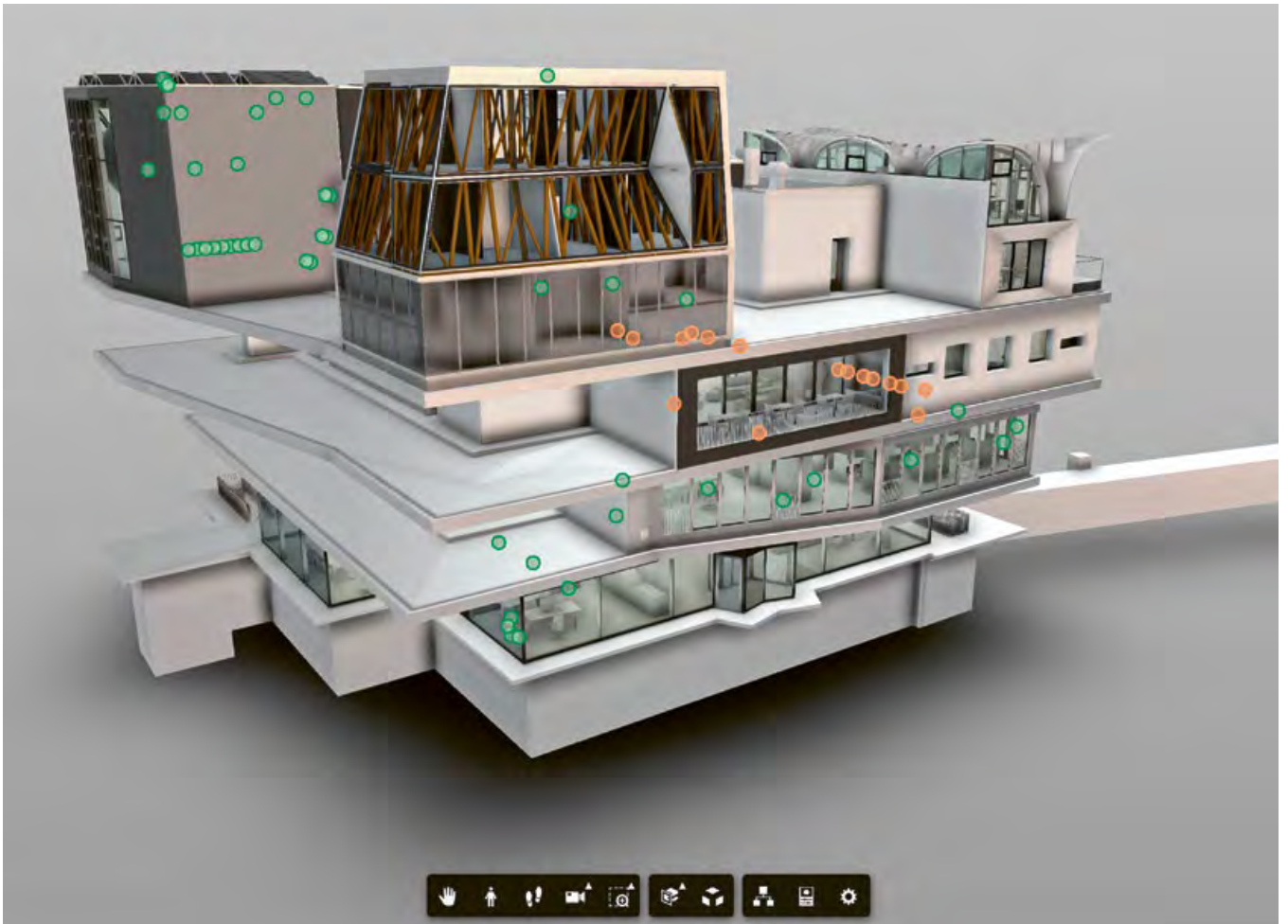
Modèle 3D alimenté par des données en temps réel: le NEST virtuel a accès aux données de plus de 700 capteurs et actionneurs. Image: Dasher 360
