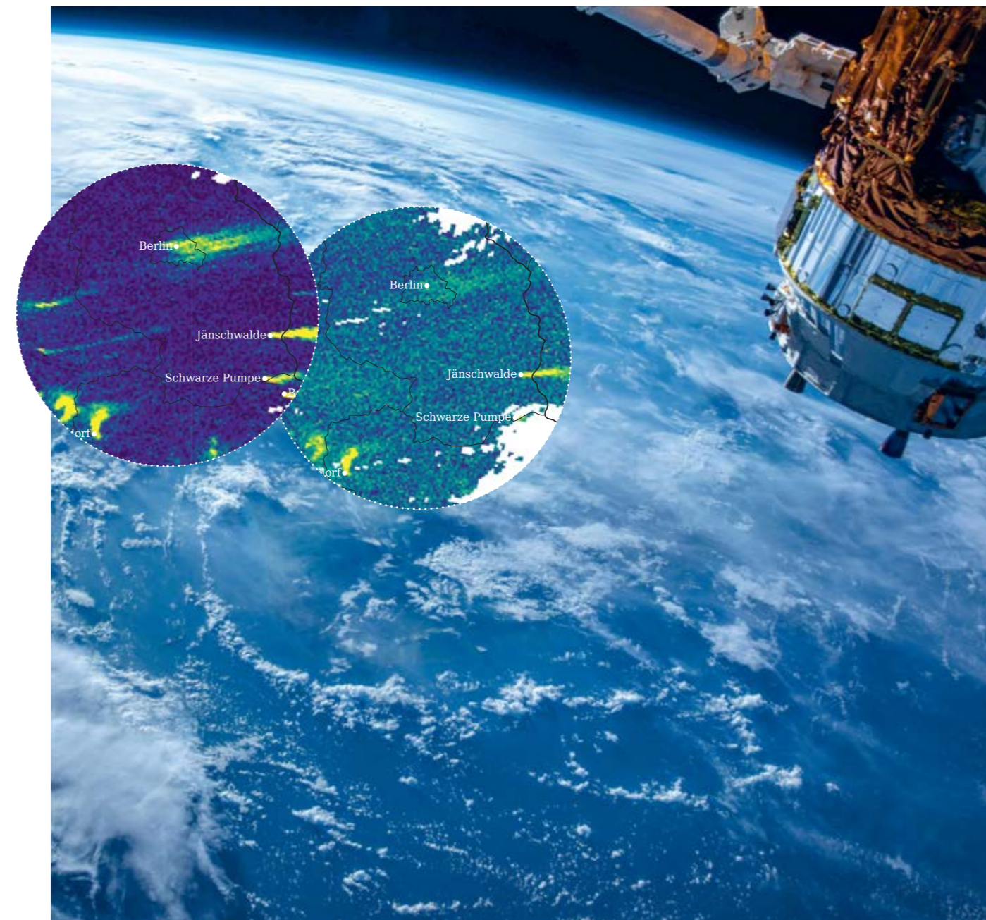
Images satellites tirées des simulations des chercheurs de l'Empa: les endroits où une forte teneur en NO 2 (à droite) coïncide avec une forte teneur en CO 2 (à gauche) sont ceux où le CO 2 est d'origine humaine. On distingue clairement les émissions de Berlin et de plusieurs centrales à charbon. L'objectif de l'UE et de l'ESA est de détecter les émissions de CO 2 en temps presque réel afin de pouvoir déterminer les émissions de gaz à effet de serre sur toute la planète de manière fiable et sans retard. Image: unsplash/NASA
