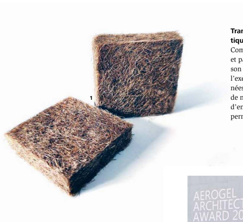
1 Ces plaques isolantes sont faites de fibres du varech récolté sur les rivages méditerranéens et souvent considérés comme une nuisance.
