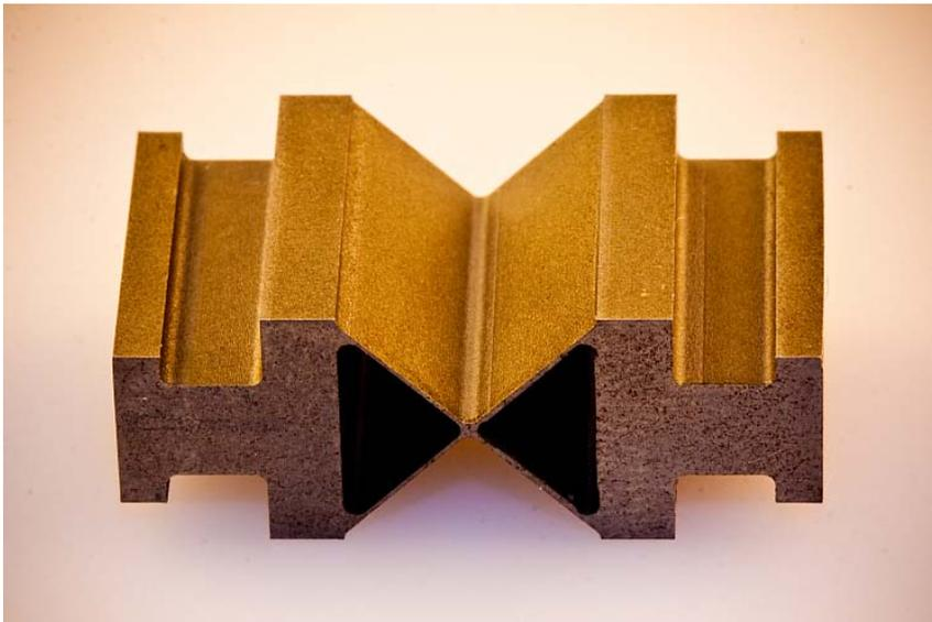
Die monolithische Lösung für eine Gelenkkonstruktion ist im Entwurf komplexer als eine traditionelle, bietet aber im Betrieb zahlreiche Vorteile. (Bildquelle: Empa)
