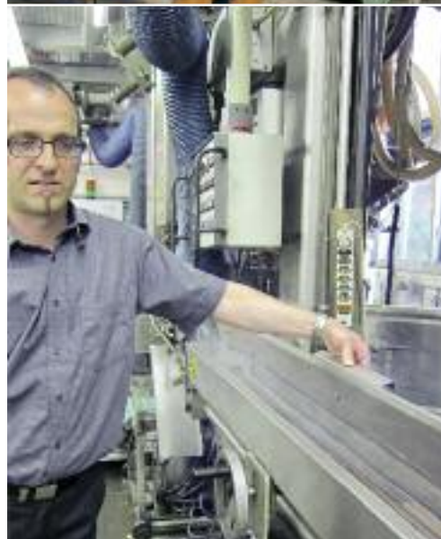
Ingenieur Peter Schmollinger durchkämmt «seine» Fabrik nach energetischen Schwachstellen. Oben: der Abroller am Anfang der Kabelfabrikation. Unten: Das Kühlbecken, durch das die Kabel laufen, wenn die Kunststoffisolierung aufgebracht worden ist.
