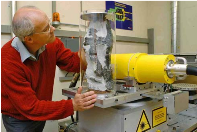
L'expert de l'Empa Alexander Flisch lors de la réalisation d'une tomographie d'un fossile.
