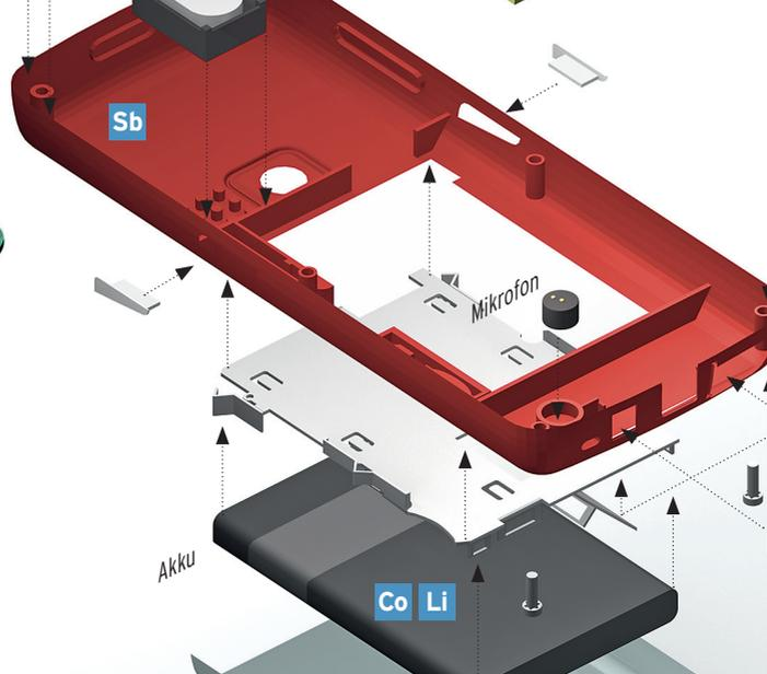
**Sb Antimon:** ein sprödes Schwermetall mit geringer Leitfähigkeit, wird als Inhaltsstoff der Bleifrei-Lote verwendet. Zudem Bestandteil der Flammschutzmittel. Wird auch in Kunststoffen (z. B. in Gehäuse, Leiterplatten) beigefügt. Herkunft: Südafrika, China.
