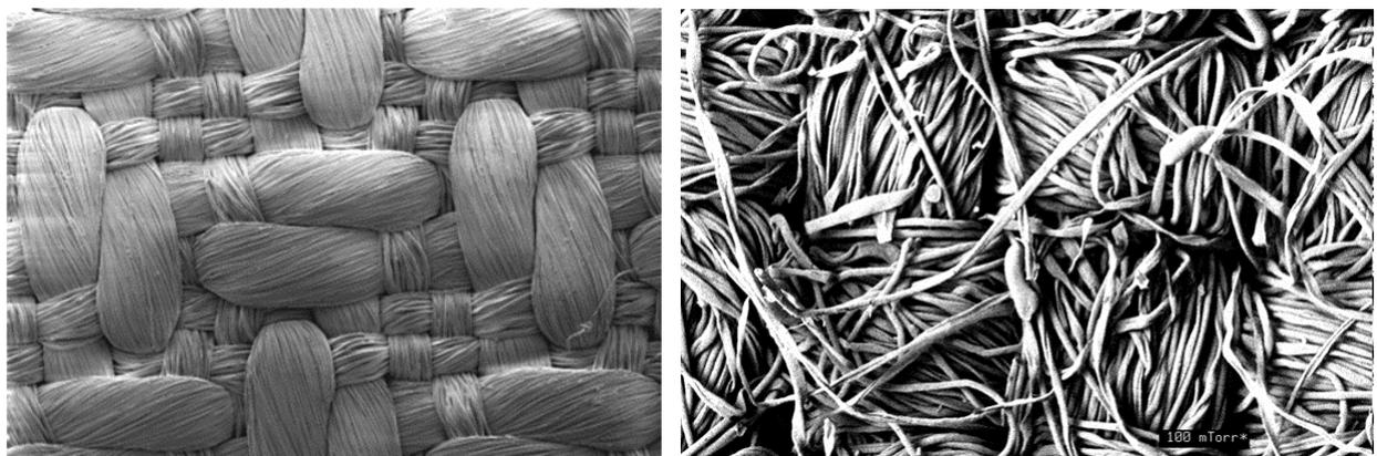
Micrographie électronique à balayage du nouveau drap (à gauche) en comparaison avec celle d'un drap conventionnel en coton (à droite) du genre de ceux utilisés dans les hôpitaux.
