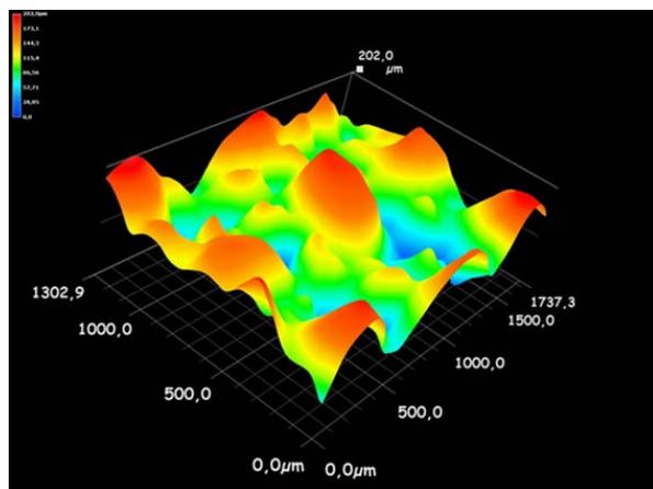
Micrographie 3D du nouveau drap avec sa surface en forme de matrice de points en relief. La structure particulière du textile offre une surface de contact plus faible avec la peau et absorbe mieux l'humidité grâce aux espaces microscopiques entre les points en relief.
