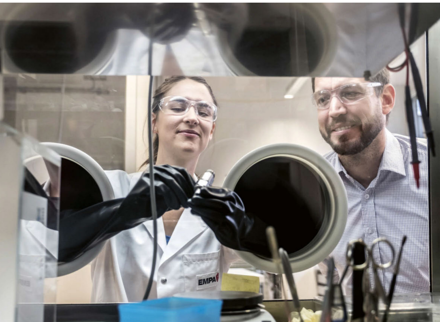
Hier entsteht der Prototyp einer neuen Batterie: Marie-Claude Bay und Corsin Battaglia arbeiten in einer sogenannten Glove-Box unter Ausschluss von Sauerstoff.
