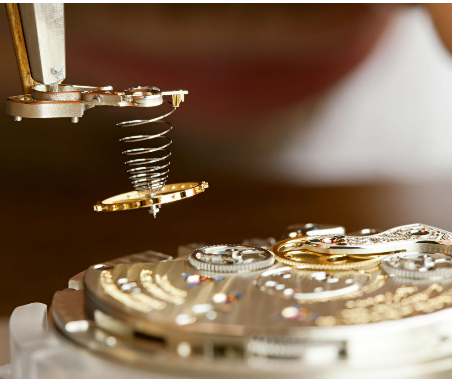
Die Unruh ist das Herzstück jedes mechanischen Uhrwerks. Die feine Feder besteht gewöhnlich aus gegossener, gewalzter Nivarox-Legierung. An der Empa werden Unruhfedern auch auf galvanischem Weg hergestellt.
