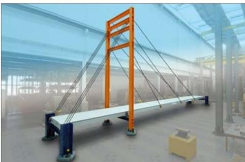
Die Empa wird an der «SMAR 2011» auch ihre einmaligen Möglichkeiten für statische und dynamische Versuche an grossen Strukturen vorstellen. Im Bild eine Leichtbau-Modellbrücke im grössten Labor der Empa. Sie dient dem Vergleich von adaptiven Dämpfungselementen, mit denen Kabelschwingungen gemindert werden.
