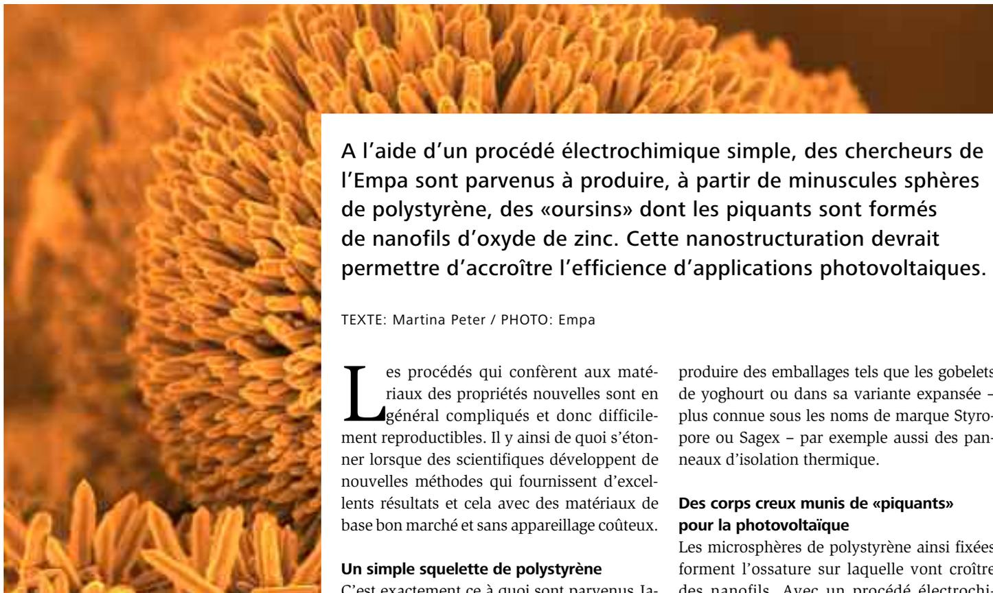
A l'aide d'un procédé électrochimique simple, des chercheurs de l'Empa sont parvenus à produire, à partir de minuscules sphères de polystyrène, des «oursins» dont les piquants sont formés de nanofils d'oxyde de zinc. Cette nanostructuration devrait permettre d'accroître l'efficacité d'applications photovoltaïques.
