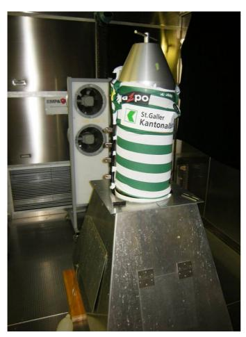
Messung des Feuchtetransportes mit flüssigem Schwitzwasser auf dem Test-Torso in der Empa-Klimakammer.
