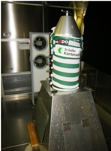
Mesure du transport de la transpiration par simulation sur le modèle de torse dans l'enceinte climatique de l'Empa.
