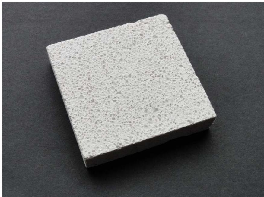
Ce nouveau crépi isolant s'applique simplement à la crépisseuse; sur la photo un bloc de crépi.
