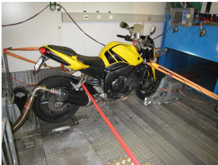
Fig. 3: Moto Euro-3 année de construction 2006, sur le banc d'essai de l'Empa.
