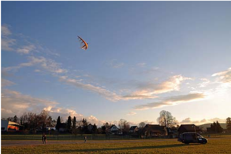
Le cerf-volant Tensairity lors d'un essai de traction sur l'aéroport de Dübendorf.
