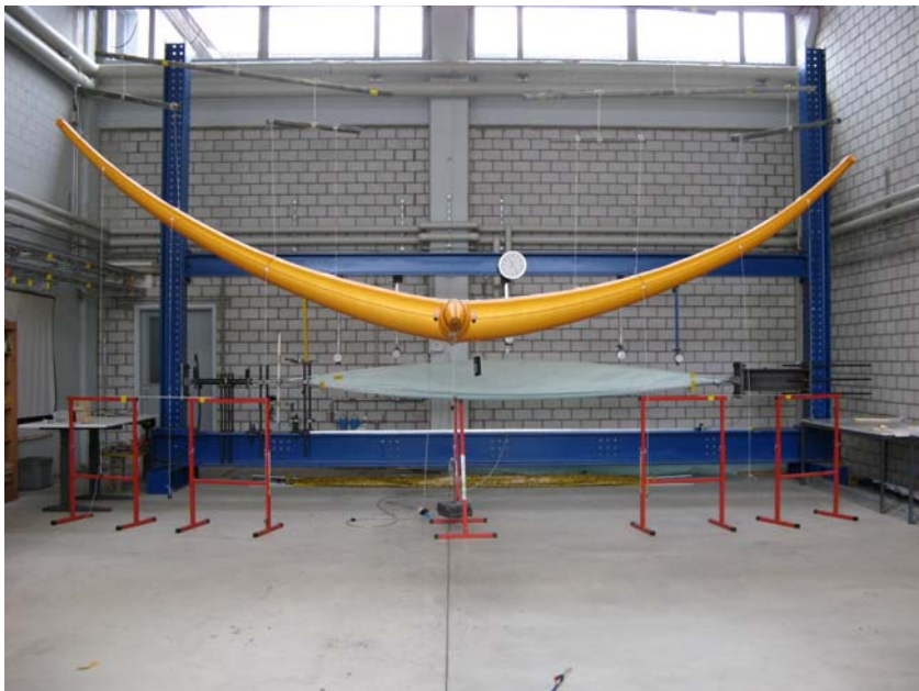
Le cerf-volant Tensairity durant les essais de charge sur le banc d'essai.
