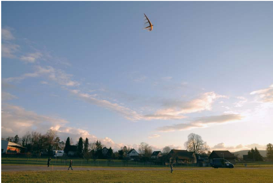
Der Tensairity-Drachen bei einem Schlepptest auf dem Flugplatz Dübendorf.
