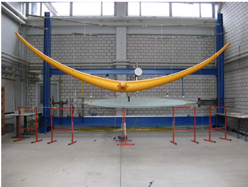
Der Tensairity-Drachen während der Belastungsprobe auf dem Prüfstand.
