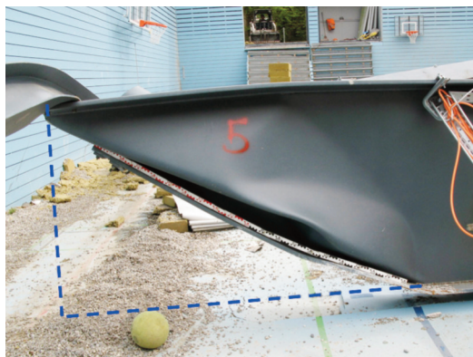
Abbildung 1: Ausgebeulte, rippenlose fensterseitige Trägerenden (blau: ursprüngliche Kontur des fensterseitigen Hauptträgerendes; rot: deformierter Steg eines Hauptträgers).
