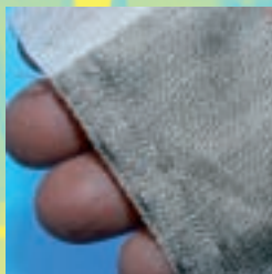
Mit Silber ummantelte Fasern können zu antibakteriell wirkenden medizinischen Textilien verarbeitet werden.
