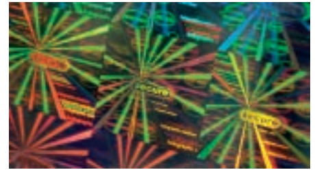
Nanostrukturen erzeugen Farben und lassen Muster erscheinen.
