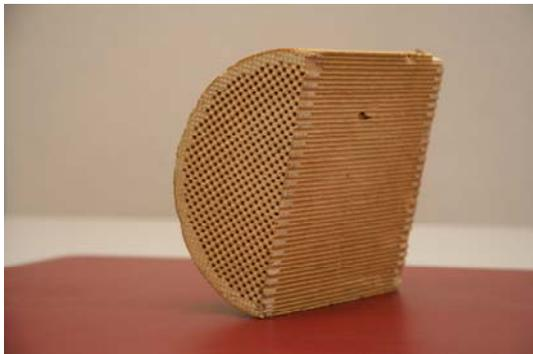
Un filtre à particules OEM, tel que ceux montés en usine par les constructeurs automobiles, découpé pour mieux montrer son mode de fonctionnement. L'extrémité de chaque canal est fermée et les gaz d'échappement sont ainsi forcés de s'écouler à travers les parois du filtre. Ce mode de filtration permet de retenir plus des 95 % de toutes les particules.
