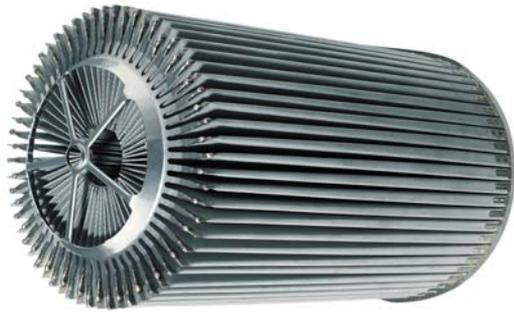
Les "entrailles" du filtre à particules de post-équipement testé: les gaz d'échappement circulent au travers de poches métalliques filtrantes. Ces poches sont plus grossières, plus poreuses et ainsi beaucoup plus perméables que les canaux d'un filtre céramique OEM (photo: HJS Fahrzeugtechnik)
