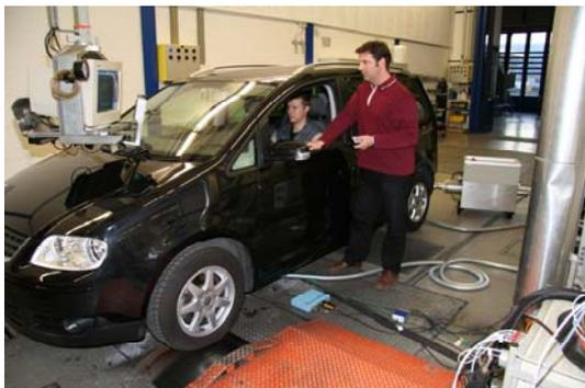
La VW Touran équipée du filtre de post-équipement testé sur le banc d'essai à roulement peu avant le début des mesures.
