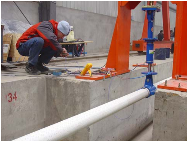
Messung der Seildämpfung mit Feedback-geregeltem MR-Dämpfer.
