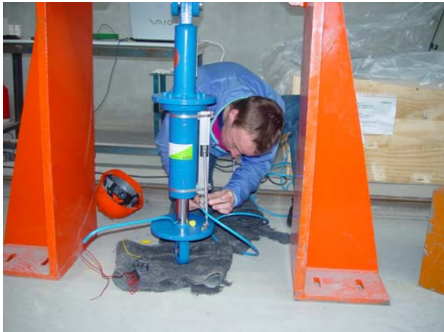
Verkabelung des «magnetorheologischen Fluidtämpfers» (MR-Dämpfer) mit der Regelungs-Hardware.
