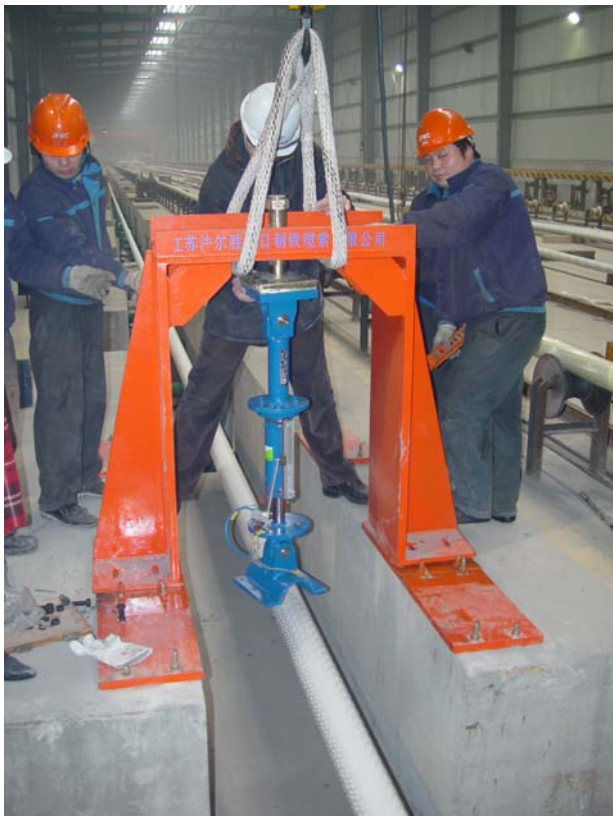
Einbau des MR-Dämpfers am Testseil an der Dämpferposition 6.6 Meter.
