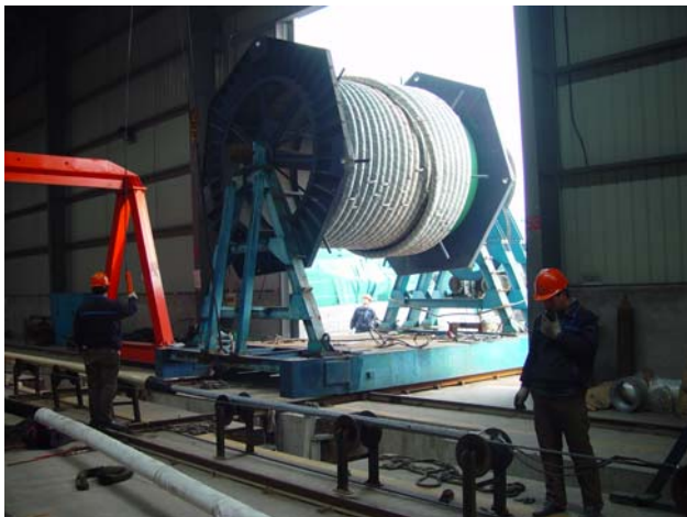
Das 228 Meter lange Originalseil wird zum 250 Meter langen Testkanal transportiert.
