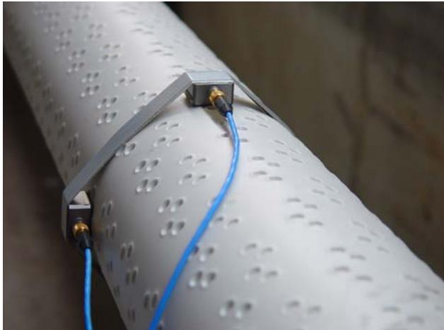
Des accéléromètres mesurent les vibrations horizontales et verticales du câble.
