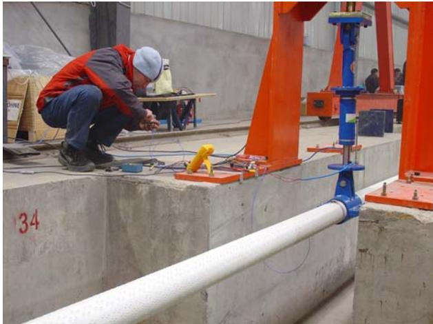
Mesure de l'amortissement de l'amortisseur MR avec réglage rétroactif.
