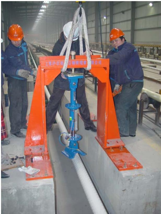
Montage d'un amortisseur MR sur le câble d'essai
