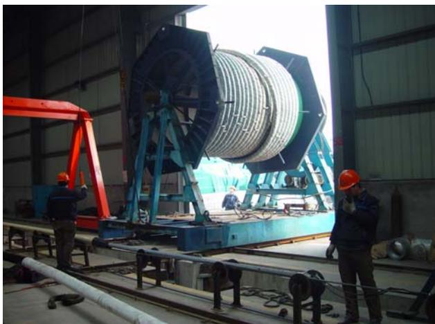
Un câble original de 228 mètres de longueur est transporté dans le canal d'essai de 250 mètres de longueur.
