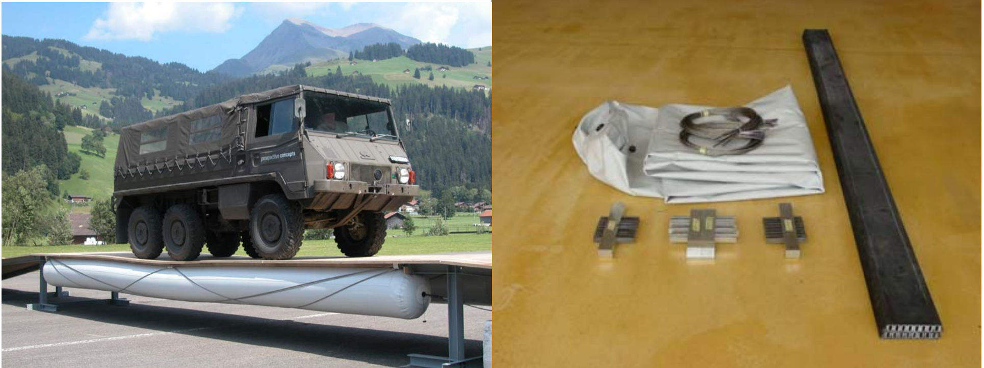
Tensairity®-Demonstrationsbrücke, 8m Spannweite, 3.5 t max. Last
