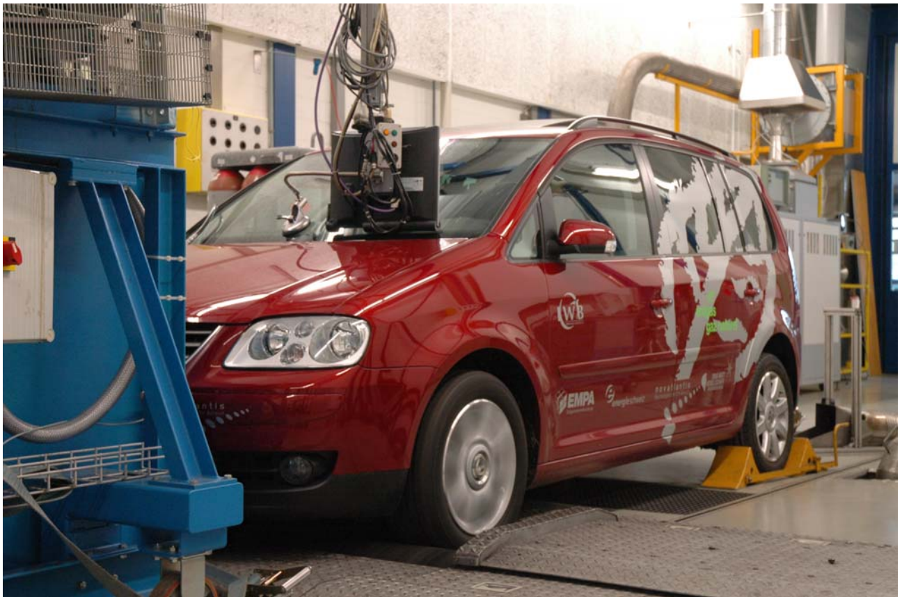
Untersuchung des Abgasverhaltens im Abgaslabor der Empa
