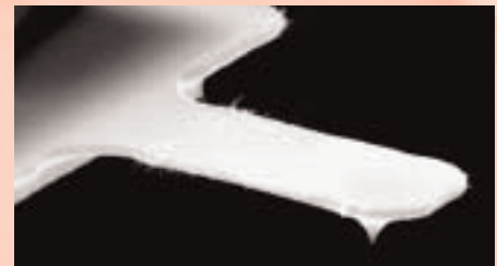
Hochempfindlicher, ultrakleiner Federbalken (Quelle: B. Hoogenboom, Uni Basel).
