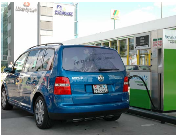
La voiture du projet Empa avec son moteur équipé pour un "vrai" fonctionnement au gaz naturel en train de faire le plein dans l'une des 60 stations-service de gaz naturel existant actuellement en Suisse.
