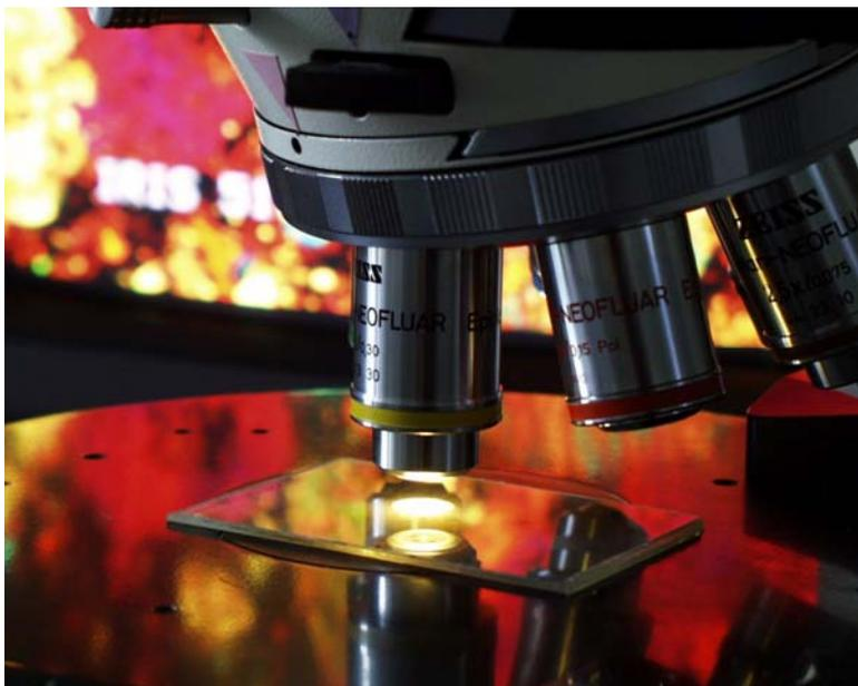
Ein Dünnschliffpräparat unter dem Polarisationslichtmikroskop.
