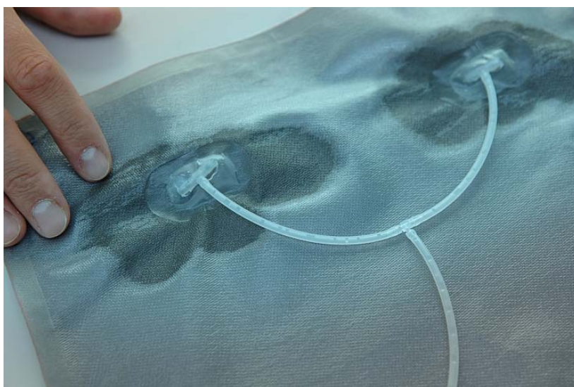
Die Kühlhose (hier ein Prototyp) wird mit 10 Millilitern Wasser befüllt und kühlt die Hautoberfläche während 40 Minuten bis zu 4° Celsius ab.
