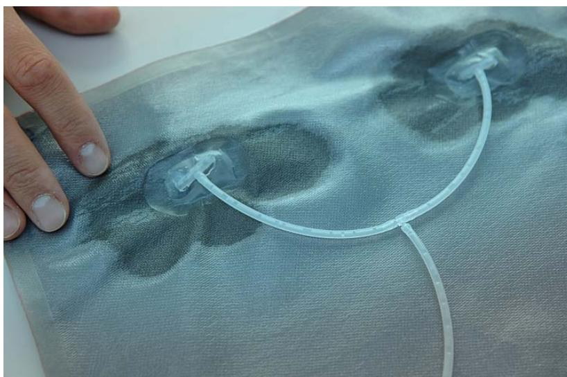
Le pantalon réfrigérant (ici un prototype) est rempli de 10 ml d'eau et provoque durant 40 minutes un abaissement de la température superficielle de la peau qui peut aller jusqu'à 4°C.
