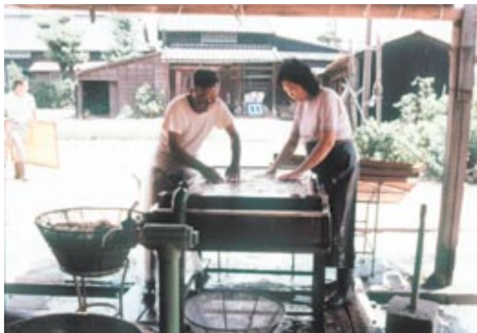
14 Die gebleichte Alge wird auf schwimmende Siebe verteilt.
