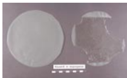
34 Klucel E in Isopropylalkohol, vor (links) und nach (rechts) der künstlichen Alterung
