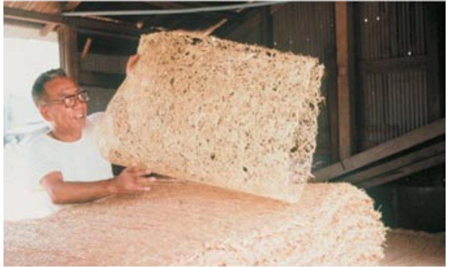
18 Das getrocknete Funori wird von den Matten gelöst.
