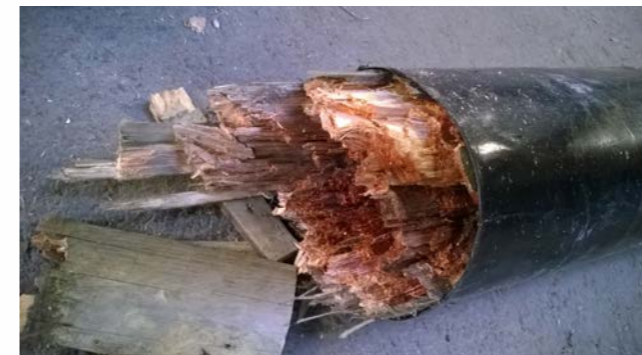
Ein hölzerner Telefonmast, von Pilzen gefällt. Mit geeigneten, ungiftigen Gegenmitteln lässt sich die Lebensdauer deutlich verlängern.
