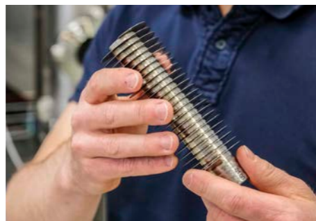
Wärmetauscher aus Durchlauferhitzern brachten die Lösung: die Natronlauge läuft spiralförmig am Rohr entlang, nimmt Wasserdampf auf und gibt Wärme ab.
