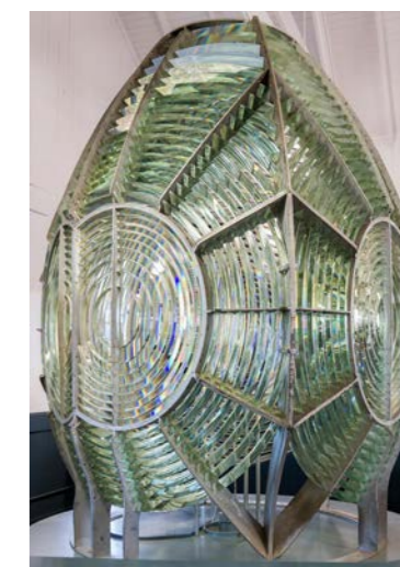
Fresnel-Linse des ehemaligen Leuchtturms Point Arena, Mendocino County, Kalifornien. Foto: Frank Schulenburg / Wikimedia.
